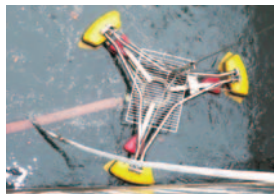
UBEエラストマーのポリエチレンペレット回収装置
