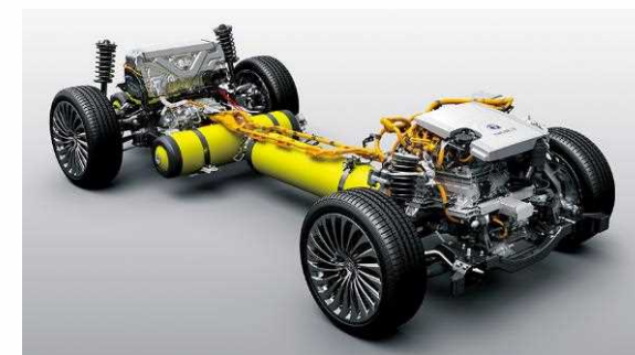
トヨタ「MIRAI」の高圧水素タンクライナー部材に採用されたコンポジットの例（ナイロン）。自動車部材が求める高い性能をエンプラのコンポジットで実現する。
