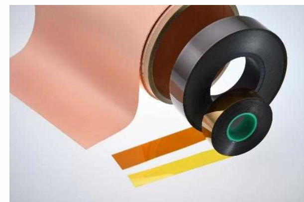
ポリイミドフィルムの例。樹脂の中で最高の耐熱性を有する。
