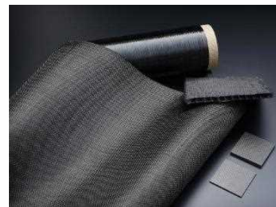
チラノ繊維®（炭化珪素繊維） 極めて高い耐熱性を有することから、今後の航空機エンジン部材の強化材として期待されている
