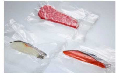
ナイロンポリマーの用途例である食品包装フィルム。酸素透過率が小さく、食品包装に適している。
