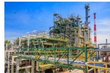
タイPCDプラント。2020年10月に2期設備が稼働。生産能力は年産8千トンに。
