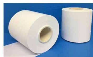
セパレータ。リチウムイオン2次電池の内部で正極と負極を隔て、ショートによる異常発熱を防止する役割を担う。
