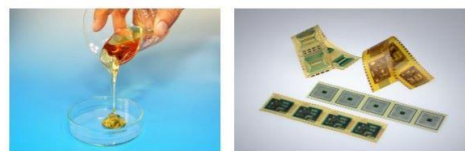
UBEのポリイミドはその特性を活かし、フレキシブルOLEDの基板や大型ディスプレイ向けCOFに用いられている *Chip-On-Film：ポリイミドフィルムの配線回路基板上にドライバICを実装
